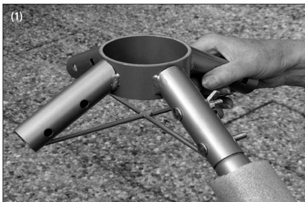
(1) Verbinden Sie mittels Schlossschrauben und Flügelmuttern die oberen Stangen mit dem zentralen Kreuz. Sie erkennen die oberen Stangen dadurch, dass sie ein Gewinde aufweisen, mit dem die horizontalen Stangen im nächsten Schritt miteinander verbunden werden.
