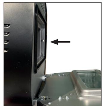
Der kleine Abstand zwischen der Tür und dem Gerät ist normal, da sich die Türdichtung im inneren der Tür befindet.
