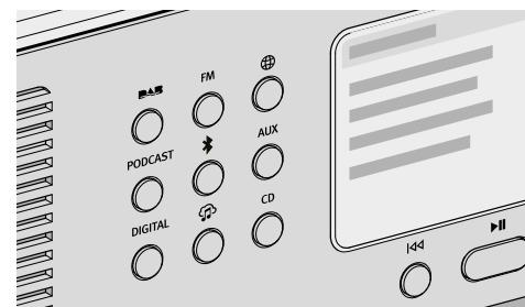
Selezione della sorgente di riproduzione tramite tasti dedicati direttamente sul dispositivo.
