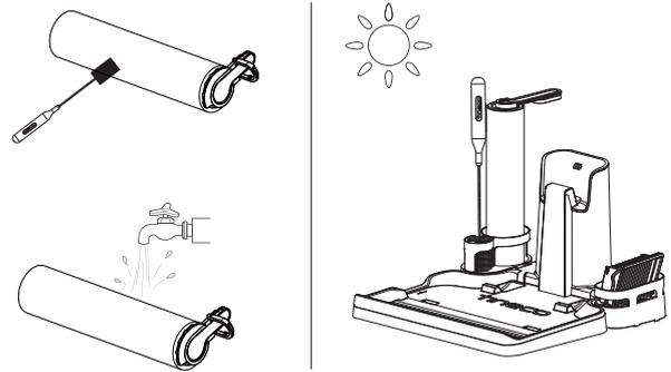
Verwenden Sie das Reinigungswerkzeug, um Haare und Verschmutzungen zu entfernen, die sich um die Bürstenrolle gewickelt haben, und spülen Sie sie mit Wasser ab. Setzen Sie die Bürstenrolle wieder in den Zubehöralter ein, nachdem sie vollständig getrocknet ist.
