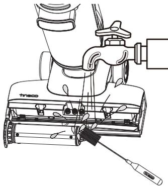
Waschen Sie das Bürstenrollenfach mit Wasser und dem Reinigungswerkzeug aus und entfernen Sie Haare und Verschmutzungen.
