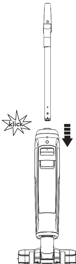
Um den Griff zusammenzusetzen, setzen Sie ihn in das Gerät ein, bis er hörbar einrastet.
