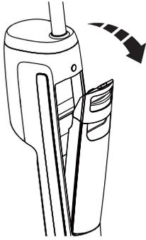
Drücken Sie die Entriegelungstaste für den Frischwasserbehälter, um ihn vom Gerät zu entfernen.
