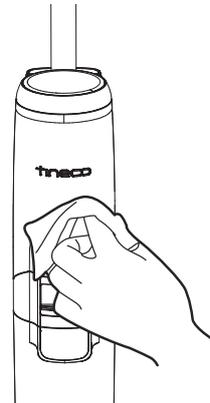
Verwenden Sie ein Tuch, um die Oberfläche mit einem neutralen Reinigungsmittel zu reinigen. Das Tuch sollte trocken sein, damit kein Wasser in das Gerät eindringen kann.
