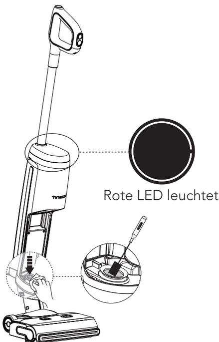
Wenn der iLOOP rot leuchtet, entfernen Sie den Schmutzwasserbehälter und reinigen Sie den Schmutzsensoren mit einem feuchten Tuch oder dem Reinigungswerkzeug.
