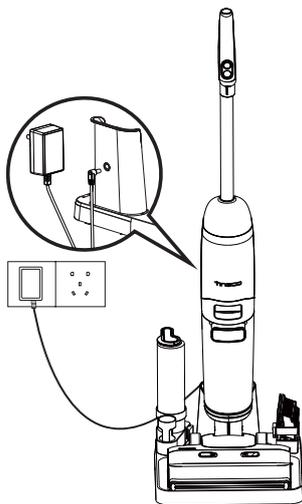
Um das Gerät aufzuladen, stellen Sie es auf die Ladestation und schließen Sie das Steckernetzteil an einer Steckdose an.
