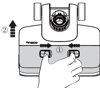
Drücken Sie die Verriegelung der Abdeckung zusammen und ziehen Sie die Abdeckung zum Entfernen nach oben.
