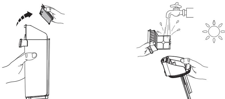
Fassen Sie den vertieften Bereich auf jeder Seite des Trockenfilters und ziehen Sie ihn nach oben. Spülen Sie den Filter unter fließendem Wasser ab. Er muss vollständig trocken sein, bevor Sie ihn wieder im Deckel des Schmutzwasserbehälters einsetzen.
