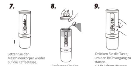
Entfernen Sie den oberen Deckel, füllen Sie das Wasser ein und setzen Sie den Deckel wieder auf. Empfehlenswert ist die Zugabe von 50 ml Wasser, um einen authentischen Espresso von 30 ml zu erhalten.
