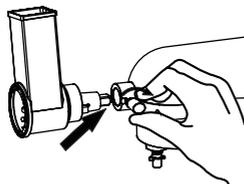
3. Setzen Sie den gewünschten Trommel-Einsatz (schneiden (3), grob raspeln (4) oder fein Raspeln (5)) in den Reibaufsatz.
