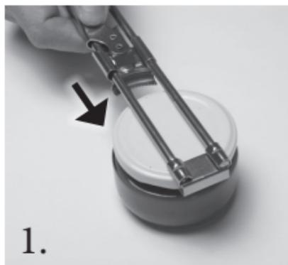
Fixieren Sie den oberen Halter mit etwas Zug an einer Seite des Deckels. Schieben Sie den unteren Halter mit Hebel und Handgriff an die gegenüberliegende Seite des Deckels.
