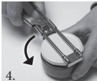
Halten Sie Hebel fest gedrückt und fixieren Sie die Dose mit der anderen Hand. Öffnen Sie nun den Deckel durch eine Drehbewegung.
