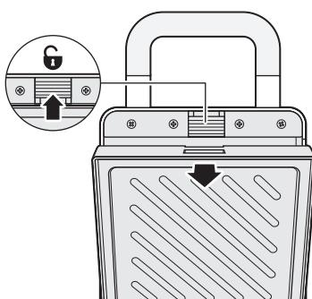
Każda płytka jest mocowana za pomocą zatrzasku blokującego w urządzeniu.
