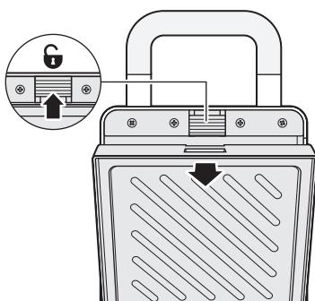
Chaque plaque se fixe à l'appareil avec un loquet de verrouillage.
