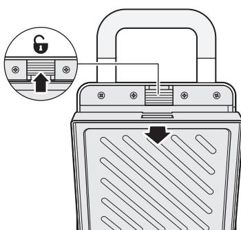
Cada placa se fija al dispositivo mediante una pestaña de bloqueo.
