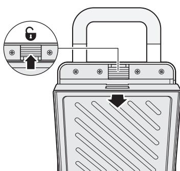
Каждая пластина закреплена на месте фиксирующей защелкой в устройстве.
