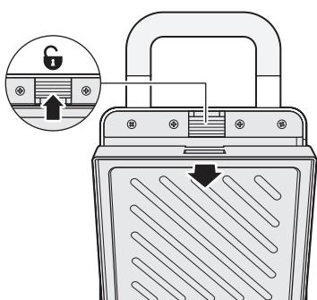
Jede Platte wird von einer Verschlusstraste im Gerät fixiert.
