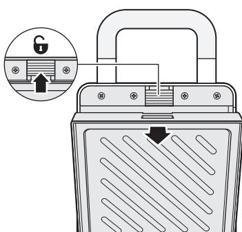
Ogni piastra viene fissata all'apparecchio mediante un fermo di bloccaggio.
