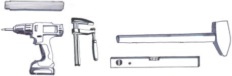
**Werkzeug:** Meterstab, Akkuschrauber, Schraubzwinde, Vorschlaghammer, Wasserwaage
