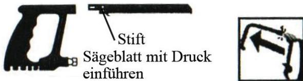
2. Ziehen Sie das Sägeblatt durch Druck auf den Stift heraus
