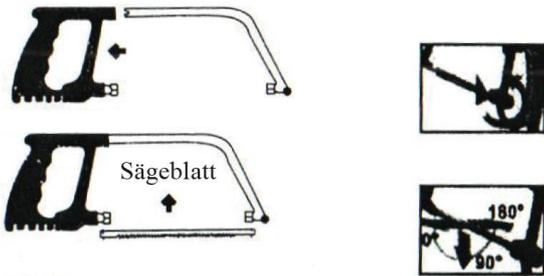
Sägeblatt mit Schnittschutzhandschuhen einsetzen
