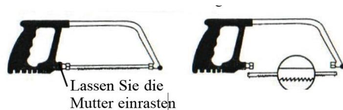
4. Ziehen Sie zur Fixierung des Sägeblatts die Mutter fest an.
