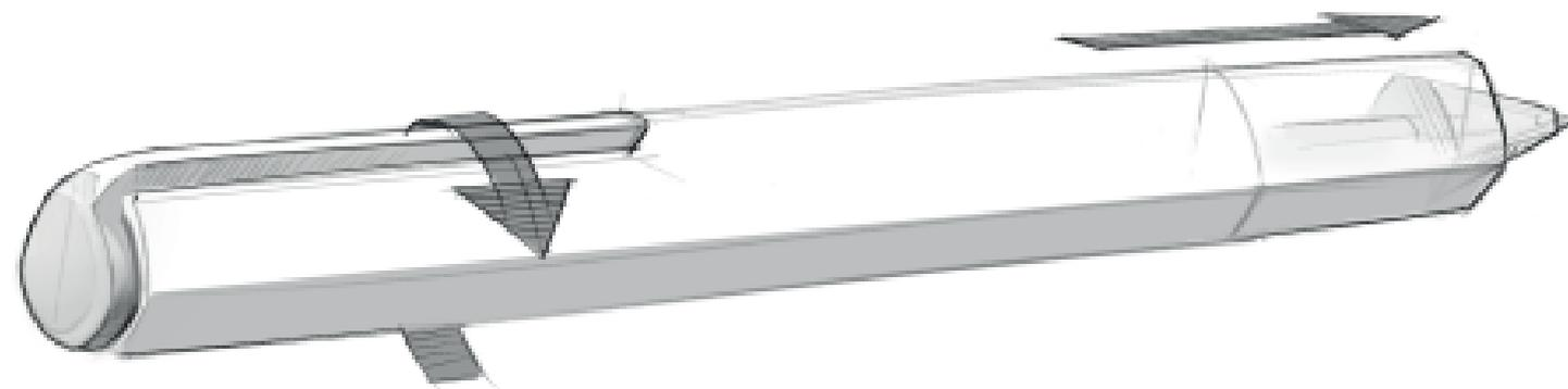
Clip im Uhrzeigersinn drehen, bis er vollständig in der dafür vorgesehenen Einkerbung am Lauf ausgerichtet ist.
