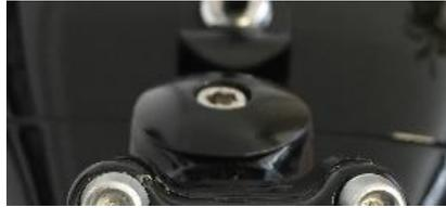
Abbildung 4: Schraube zum Einstellen des Lenklagers
