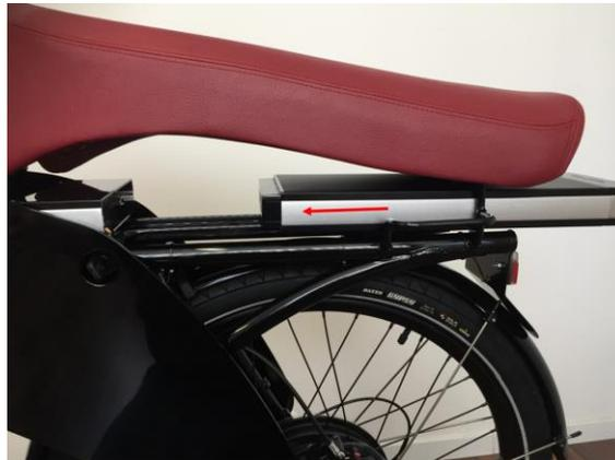
Abbildung 5: Montage des Akkus in Pfeilrichtung
