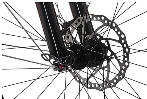
Abbildung 1: Ansicht auf Steckachse
