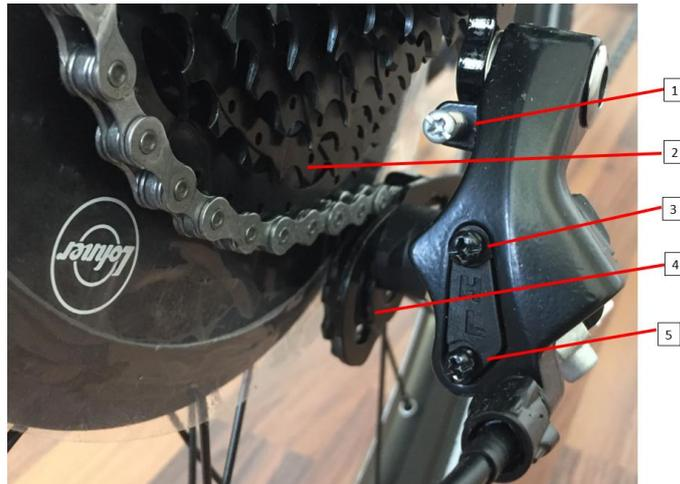
Abbildung 23: Einstellschrauben am Kettenwerfer
