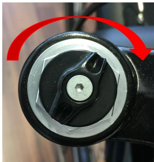
Abbildung 13: Härte der Federgabel – In Pfeilrichtung wird diese straffer
