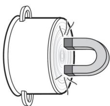
Si assicuri, che il recipiente rechi un avviso, che attesti l'idoneità alla cottura con un flusso induttivo o esegua il seguente test magnetico:
