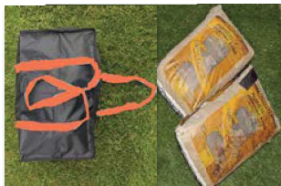
Abbildung 1 - Bremsack mit 45-50 kg Sand befüllen
