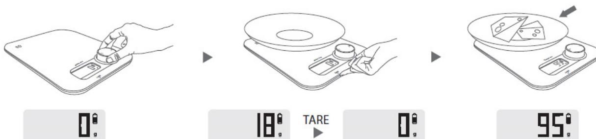
Posizionare un contenitore qualsiasi sul piatto di pesatura. Sul display LED viene visualizzato il peso del contenitore.
