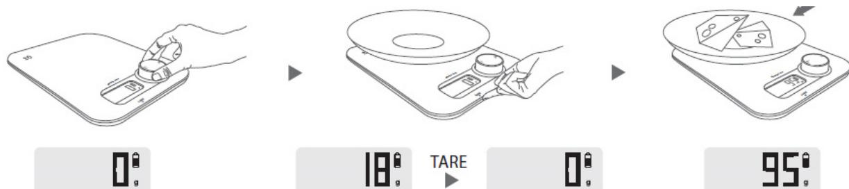
Colocar un recipiente en la bandeja de pesaje, la pantalla LED muestra el peso del contenedor.
