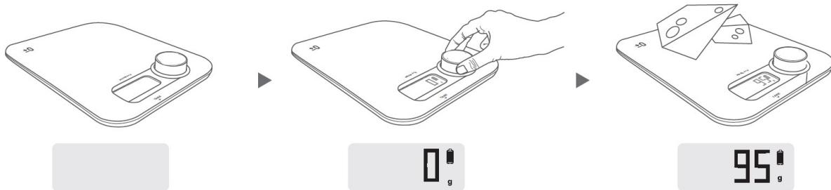
Ruotare il pomello in senso orario finché sul display appare 0.
