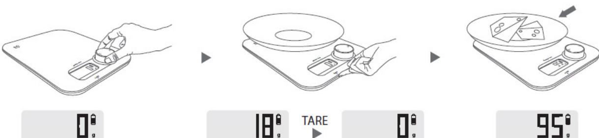
Plaats een container op het weegvlak, het LED-scherm toont het gewicht van de container. Raak het frame van de behuizing aan bij het opschrift TARE, .op het display op nul. Dus het gewicht van de container verwijderd en u kunt weegt de inhoud van de container.
