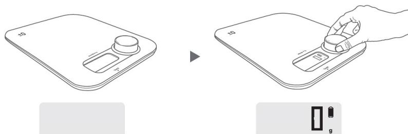
Draai de knop met de wijzers van de klok mee tot er 0 in het display verschijnt en de condensator door dynamotechnologie volledig is opgeladen.
