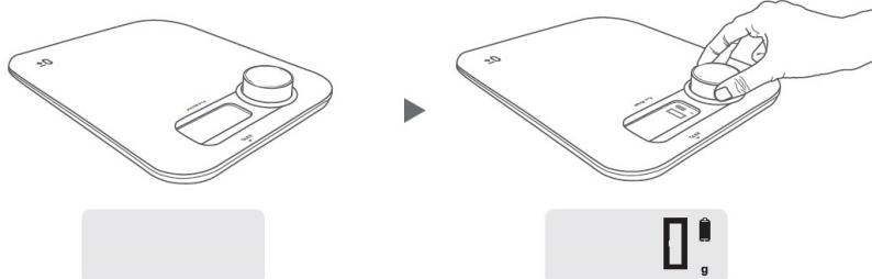
Gire el selector a derechas hasta que en la pantalla se muestre la indicación 0 y, por tanto, el condensador esté cargado mediante la tecnología de dinamo.
