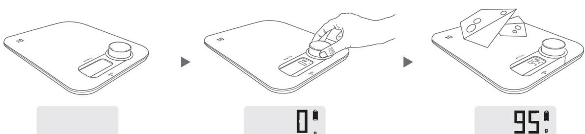
Tournez le bouton dans le sens des aiguilles d'une montre jusqu'à ce que "0" s'affiche à l'écran. Posez la balance sur une surface stable et plane.
