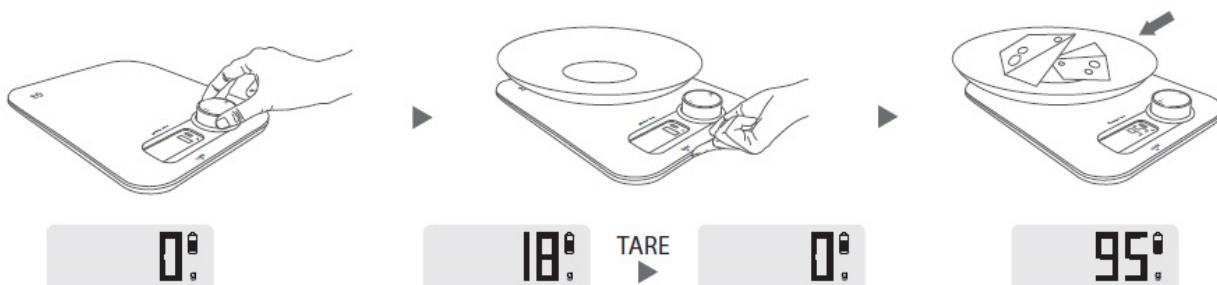
Stellen Sie einen Behälter auf die Wiegefläche, das LED Display zeigt das Gewicht des Behälters an.
