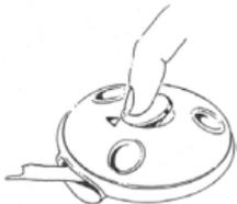
b) Fixieren: Chip (gewölbte Seite nach oben) in die Gehäusemulde drücken.
