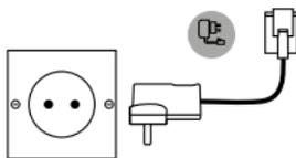
1. Netzkabel mit dem roten Stecker an der entsprechend gekennzeichneten Buchse
