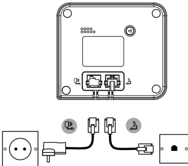
1. Das Telefonkabel an der entsprechend gekennzeichneten Buchse
