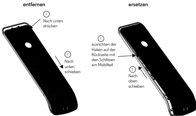
1. Die Abdeckung leicht drücken und nach unten schieben um diese vom IT.6T Mobilteil zu entfernen.
