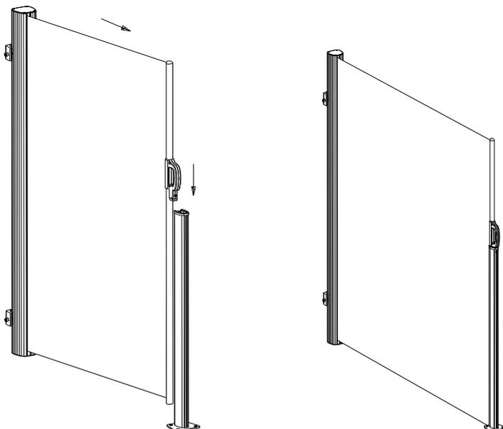
2. Um die Markise zu schließen, lösen Sie den Stift aus der Halterung und ziehen Sie die Markise langsam zur Wandkassette zurück.
