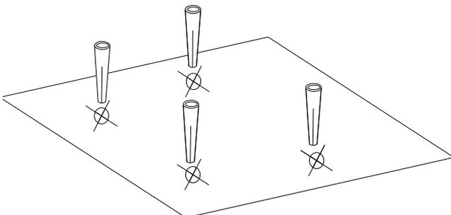
7. Richten Sie die Standsäule wie unten gezeigt aus und befestigen Sie die Säule mit den vorgesehenen Sechseckbolzen.
