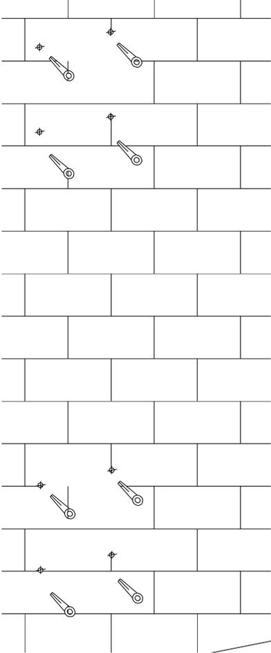
3. Befestigen Sie jede Halterung mit vier 8x40mm Quergewindeschrauben
