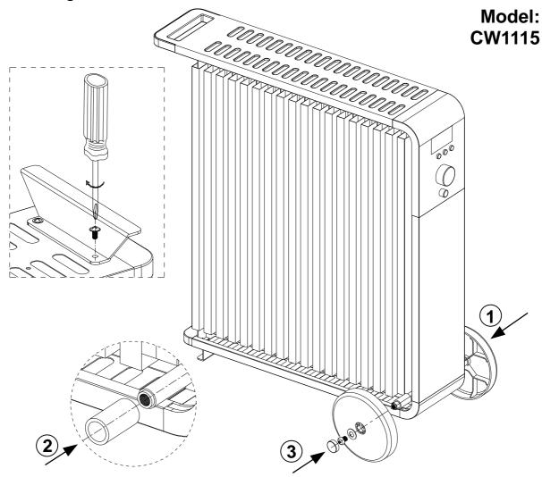
3. Für CW2-Modelle: Montieren Sie die zwei Räder, Radträger, Ringhalter, Rollen, Schrauben und Kappen am Heizgerät.
