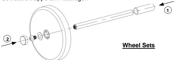
Für CW1-Modelle: Fixieren Sie den Fuß mit den zwei M3-Schrauben an der Unterseite. Montieren Sie dann das Radset am Heizgerät.
